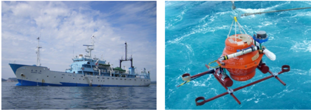
図 1. (左) 海底地震計の設置・回収を行った長崎大学水産学部練習船・長崎丸 (842 t)。 (右) 投入直前の海底地震計。オレンジ色のハードハット内に観測機器を封入した耐圧ガラス球が入っている。
