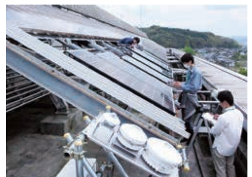
◀実際の桜島火山降灰の影響把握を目的に設置された暴露試験用太陽電池モジュール
