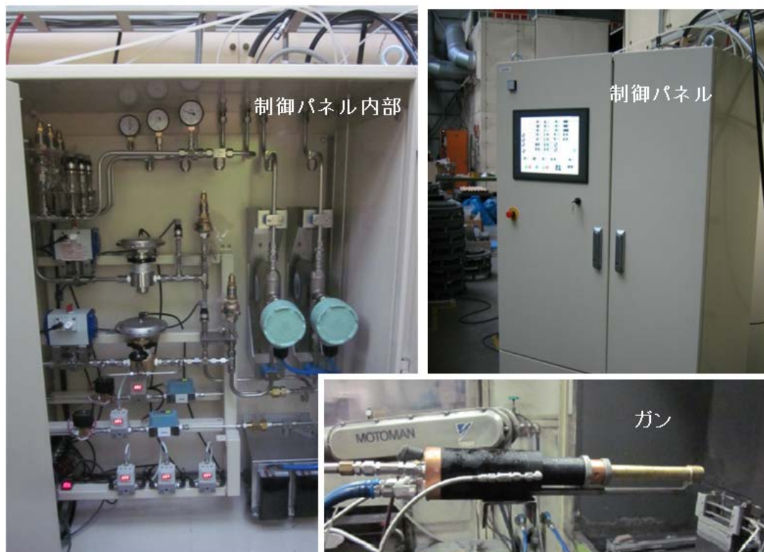
図 3 開発された高圧型ウォームスプレー装置の外観。制御パネル内には流量制御バルブ等が収納され PC 制御による自動化を実現、全自動で着火し所定の窒素ガス混合状態に到達・維持する機能を有する。
