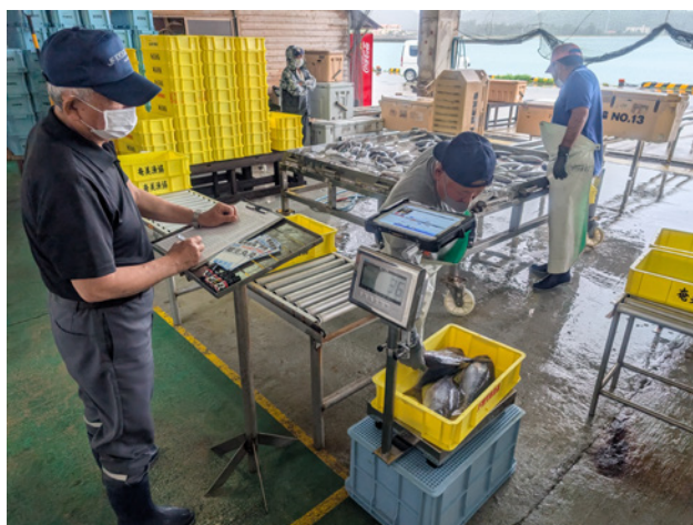
▲ 左側は従来の手書き伝票、右側は自動計量システム（漁獲物を載せた瞬間に魚の種類や量、サイズなどがデジタルデータとして記録される）
