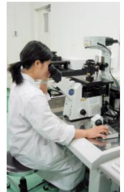
BSE対策研究室に設置された共焦点レーザー走査顕微鏡
