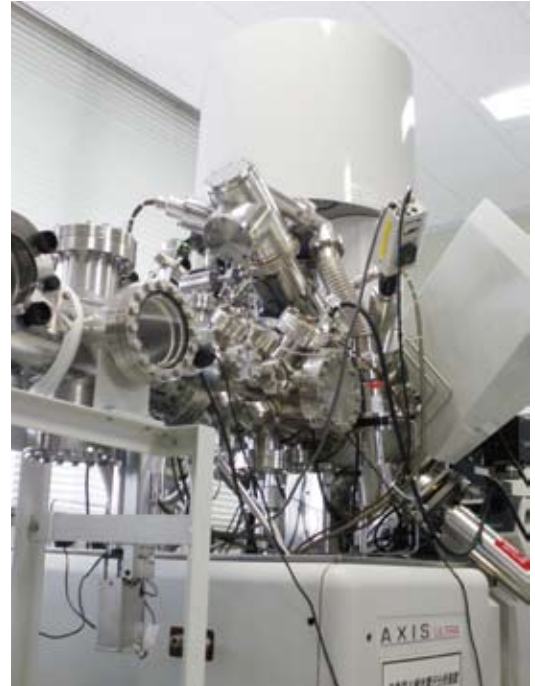
▲走査型X線光電子分析装置(島津AXIS-ULTRA DLD)
