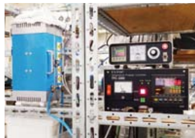
▲バガスの水熱処理分解物質から燃料を合成するための実験装置
