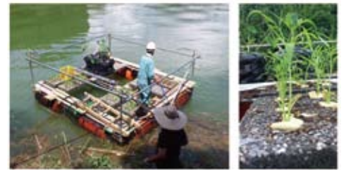
▲アオコ対策法：筏設置状況と空心菜によるダム湖内栄養塩回収実験
