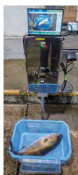
◀ 水産物AIスマート計量システム：魚を計量器の上に載せるだけで魚種をAI判別して、魚の大きさや生産者情報をデジタル化するシステム
