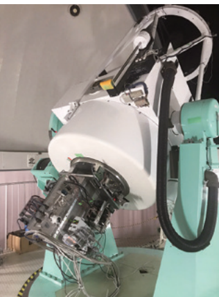
◀入来観測所に設置されている1m赤外線望遠鏡とkSIRIUS。kSIRIUSは、近赤外の3波長帯を観測できるカメラであり、本学教員と大学院生によって手作りされた。
