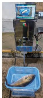
◀ 水産物AIスマート計量システム：魚を計量器の上に乗せるだけで魚種をAI判別して、魚の大きさや生産者情報をデジタル化するシステム
