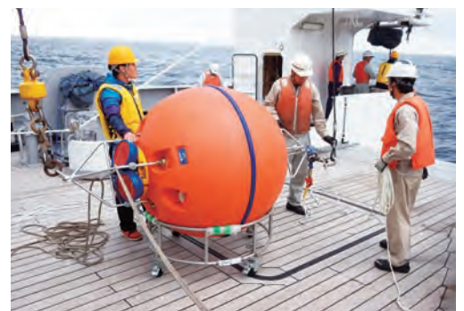
◀ 潮流計測器の設置作業(かごしま丸にて)
