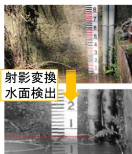
写真2 画像による水位計測
