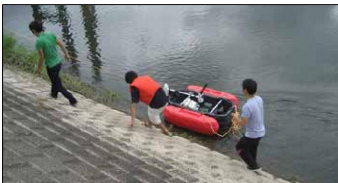
写真-1 河道形状計測に活用する測深器搭載ポート
