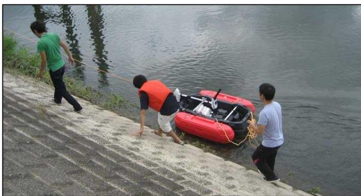
写真-1 河道形状計測に活用する測深器搭載ゴート
