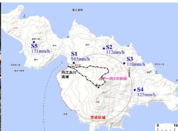
図4 浸透能試験結果
