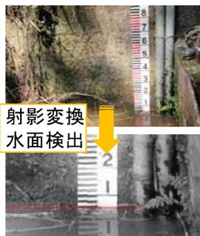
写真2 画像による水位計測
