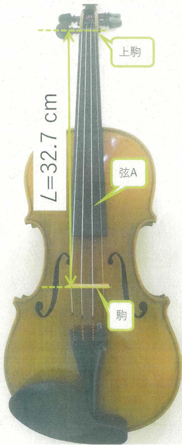
図 1：測定に用いたバイオリンの写真。 矢印の長さは弦 A の振動領域の長さ L を表す。
