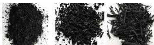
a) 牛ふん炭化材 b) し尿污泥炭化材 c) 刈草炭化材 図2 熱分解ガス化装置により作製された炭化材
